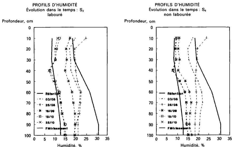
Figure 2. Profils d'humidité sur les parcelles labourées (S<sub>2</sub>) et non labourées (S<sub>6</sub>).
