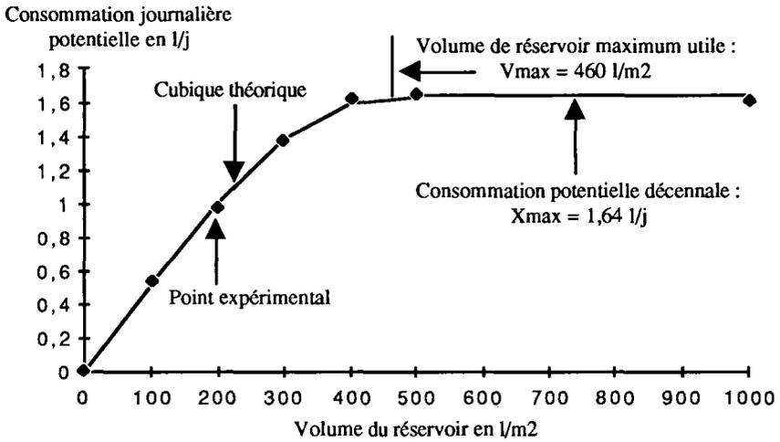
Figure 7. Ajustement d'un modèle théorique « consommation-volume » pour la station de Kaélé dans des conditions décennales.
