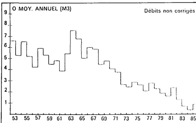
**Figure 8.** Débits moyens annuels au site du barrage (obtenus par corrélation avec le poste de Douna).
