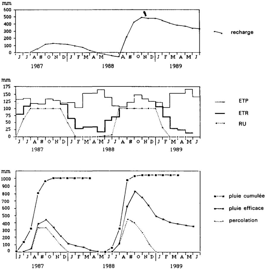
Figure 4. Bilan hydrique à la station de Golem.
