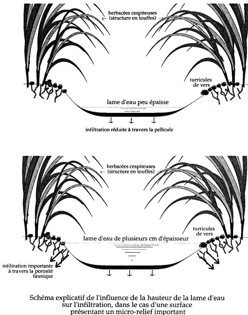
Schéma explicatif de l'influence de la hauteur de la lame d'eau sur l'infiltration, dans le cas d'une surface présentant un micro-relief important
