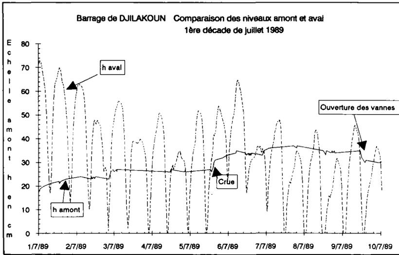
Figure 2. Barrage de Djilakoun. Comparaison des niveaux amont et aval, 1<sup>re</sup> décennie de juillet 1989.
