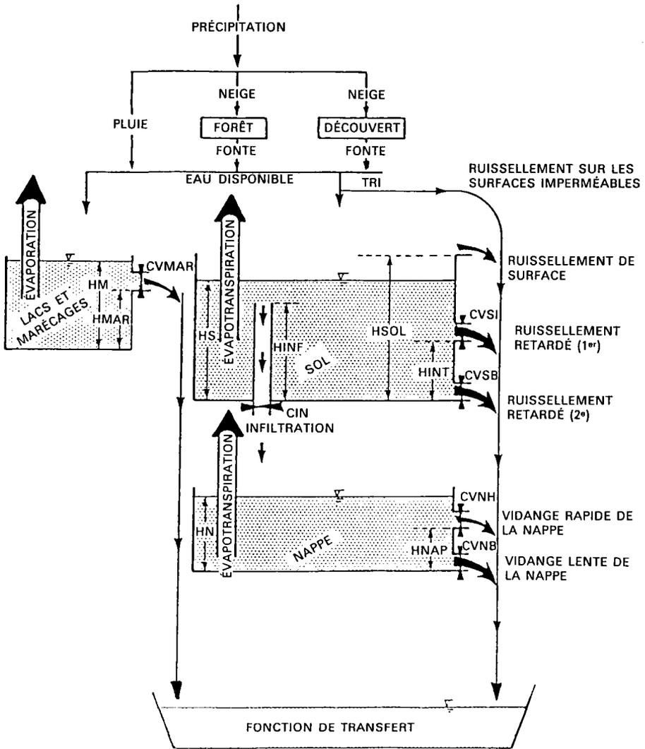
Figure 2. Schéma de production du modèle CEQUEAU.
