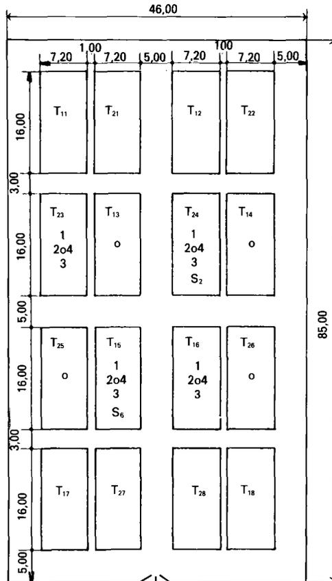
**Figure 1.** Plan de la parcelle expérimentale. T1 : Parcelle non labourée. T2 : Parcelle labourée à billons cloisonnés. o : Tubes sonde à neutrons. 1, 2, 3, 4 : Batterie de tensiomètres (20-40-60-100 cm). I : Entrée. Cotes en mètres.
