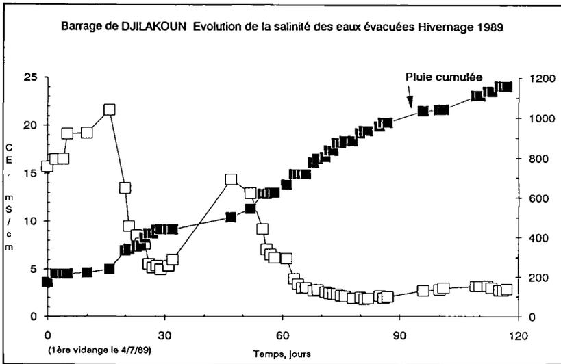
**Figure 8.** Barrage de Djilakoun. Évolution de la salinité des eaux évacuées. Hivernage 1989.
