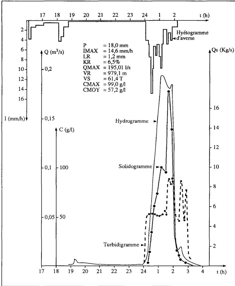
Figure 3. Bassin versant expérimental BS 21 II : crue des 3 et 4 avril 1984.
