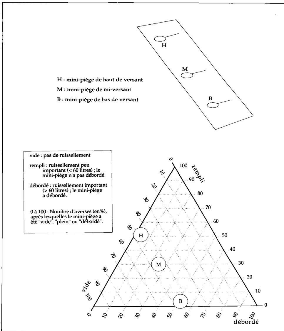
**Figure 2.** Schéma explicatif de la méthode d'interprétation des résultats. **2a** : un exemple de localisation pour trois mini-pièges. **2b** : présentation des résultats sur un diagramme ternaire : cas de l'exemple théorique ci-dessus.
