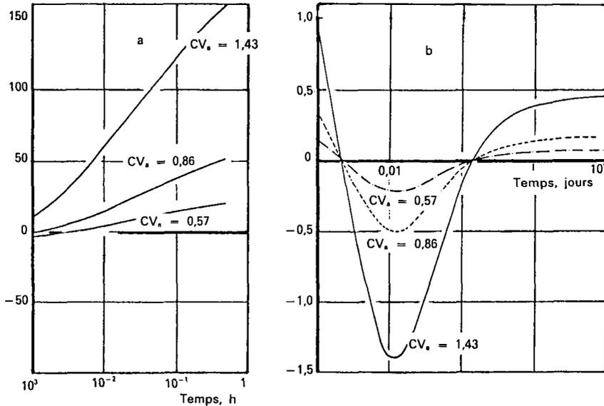
**Figure 7.** Étude de sensibilité de l'écart relatif entre moyennes stochastiques et déterministes au coefficient de variation du facteur d'échelle :  $CV_z = 0,57$  correspond à la variabilité observée ( $\sigma_L^2(n\alpha = 0,2782)$ );  $CV_z 0,86$  et  $CV_z = 1,43$  correspondent à  $2\sigma^{L^2}n\alpha$  et  $4\sigma^{L^2}n\alpha$  respectivement : a. flux d'infiltration; b. flux de drainage à la cote  $z = 110$  cm.
