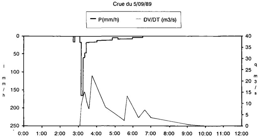
Figure 7. Crue du 5/09/89 (— P(mm/h) (— DV/DT (m<sup>3</sup>/s).
