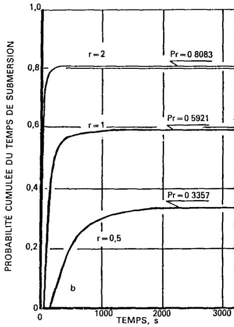
Figure 9. Loi de distribution du temps de submersion pour 3 valeurs du flux  $q_0$  à la surface :  $0,5 K^*$ ;  $K^*$  et  $2 K^*$ . Pr est le pourcentage de flaques en régime permanent.
