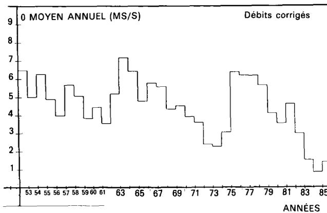
**Figure 5.** Débits moyens annuels « corrigés » au site du barrage (en m<sup>3</sup>/s).
