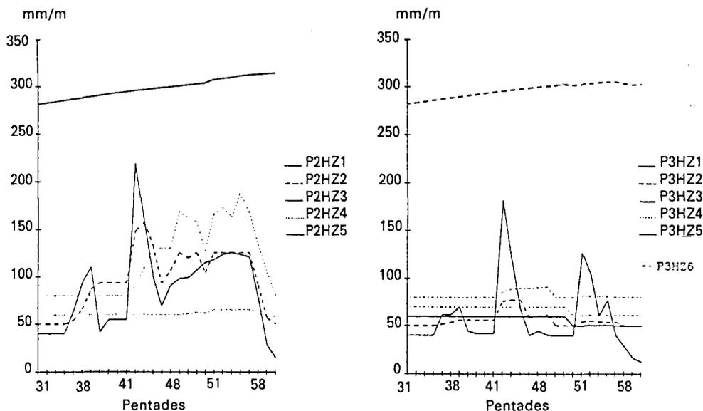
**Figure 10.** Evolution des humidités simulées de différents horizons (HZ) des deux pédon cultivés P2 et P3. Pluviométrie 1987. « Aménagé et labouré ».
