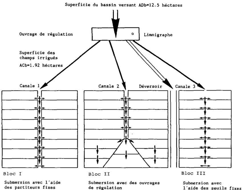
Figure 3. Systeme de distribution d'eau du périmètre B.
