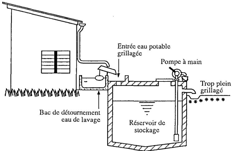
**Figure 10.** Récupération des eaux de pluie sur la toiture d'une maison et stockage dans un réservoir ferrociment enterré.
