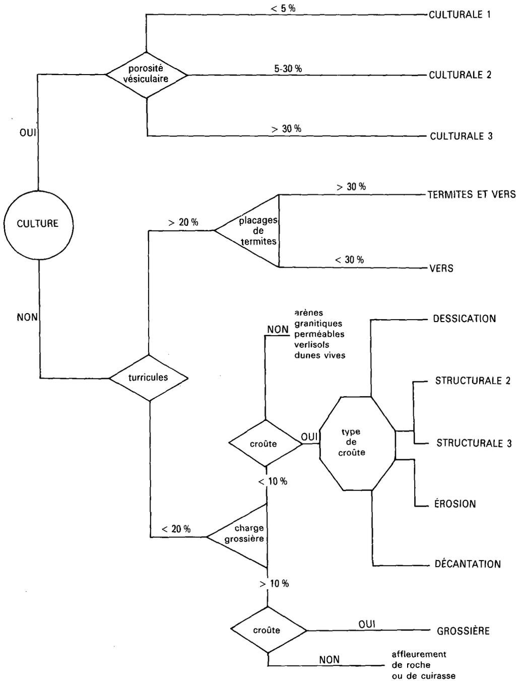
Figure 2. Clé de détermination des types de surfaces élémentaires.
