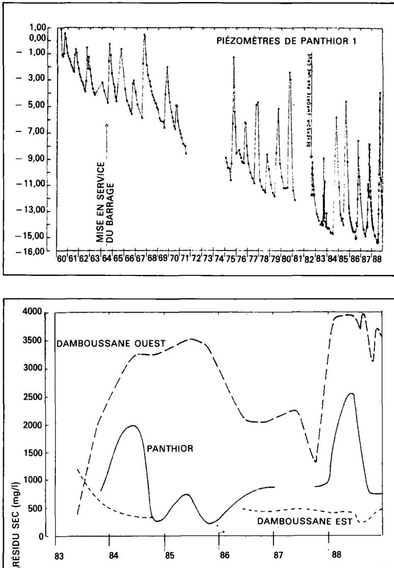
Figure 3. Fluctuations des niveaux piézométriques de Panthior 1. b : résidu sec sur les piézomètres de Panthior.
