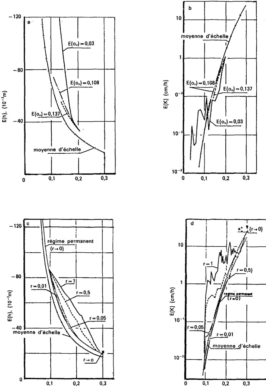
Figure 11. Propriétés effectives calculées pour différentes valeurs d'humidité initiale (11a et 11b) et du flux réduit  $r = q_0/K^*$ . (11c et 11d).
