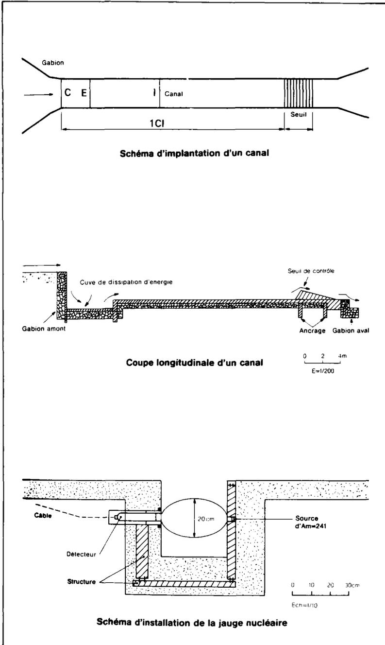
Figure 2. Dispositif de mesure type sur microbassin.
