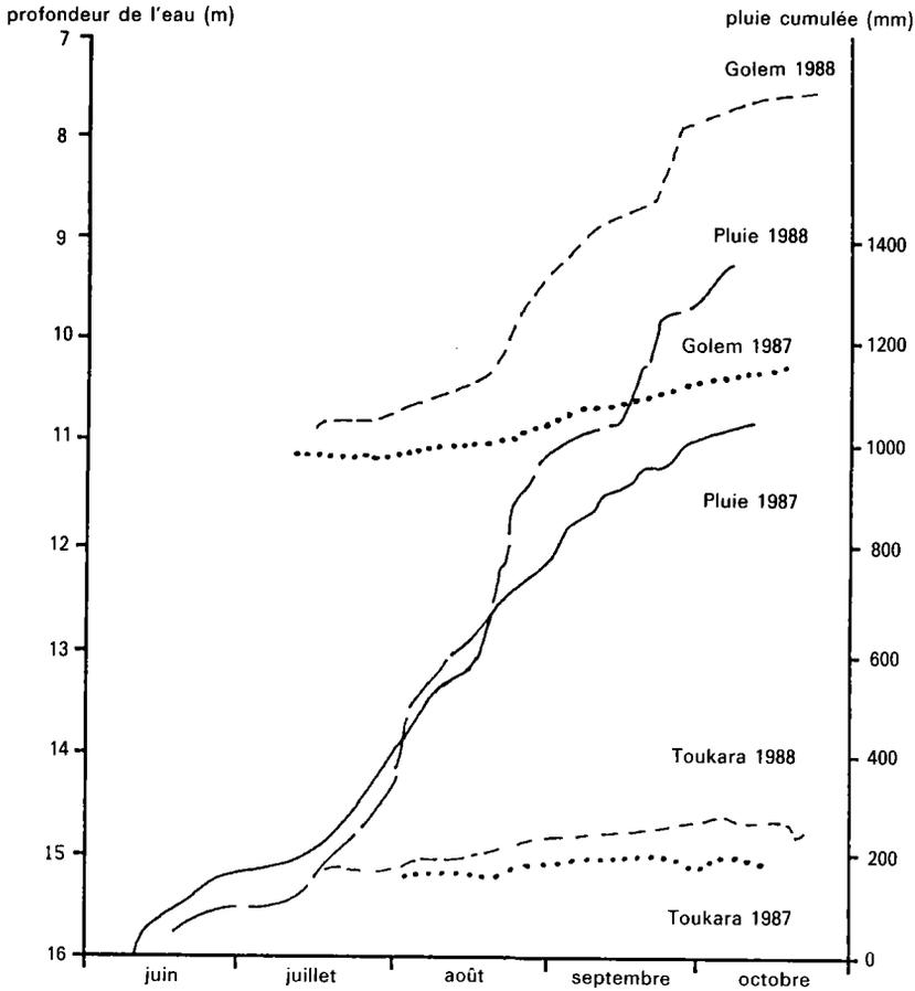
**Figure 5.** Comparaison des recharges 1987 et 1988 sur les puits de Golem et de Toukara (pluies cumulées et niveaux piézométriques).
