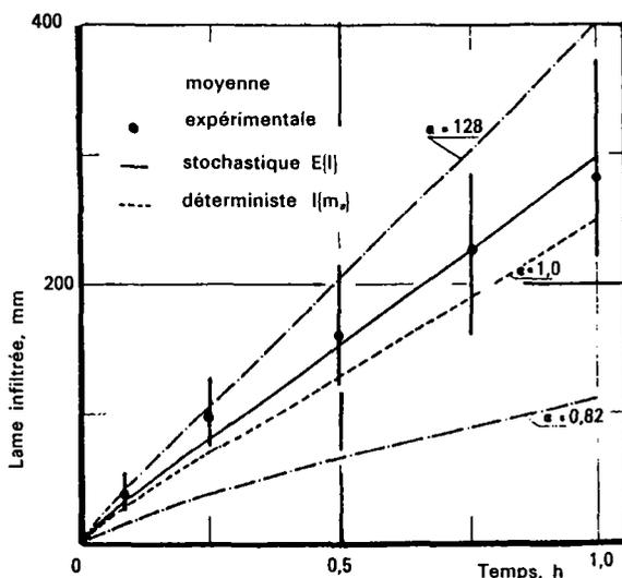
Figure 5. Évolution en fonction du temps de la lame infiltrée. Les barres verticales correspondent au domaine de variation des valeurs mesurées sur les 23 sites.
