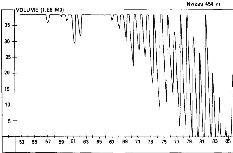
**Figure 9a.** Simulation. Niveau initial de la retenue : 454 m. (Débits estimés par corrélation avec le poste de Douna.)
