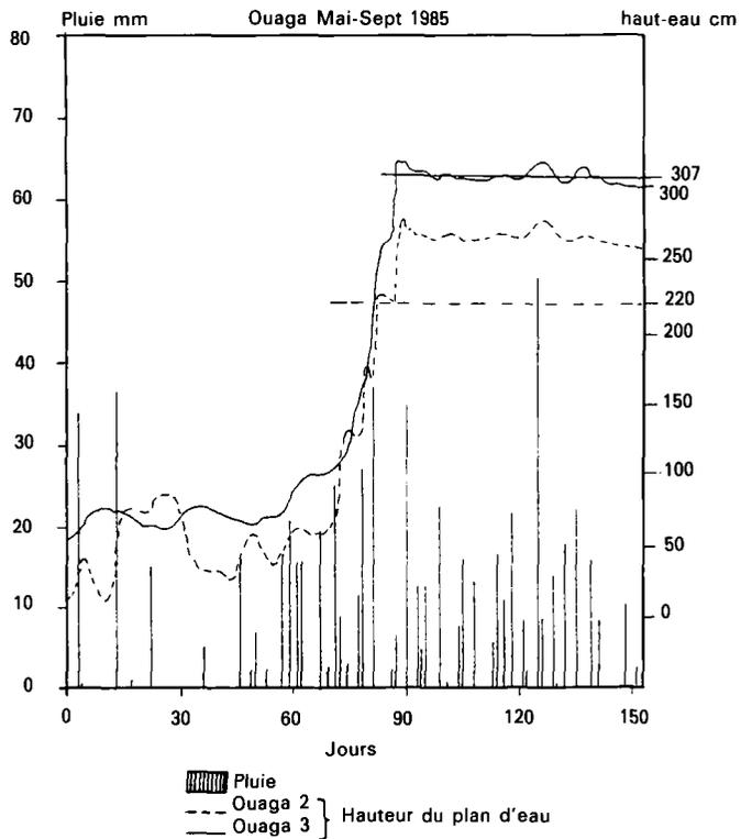
Figure 7. Relation entre la pluviométrie et le remplissage des barrages (1985).
