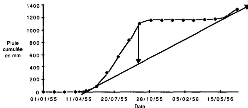
Figure 3. Détermination d'un volume de réservoir minimal pour une consommation potentielle maximale.
