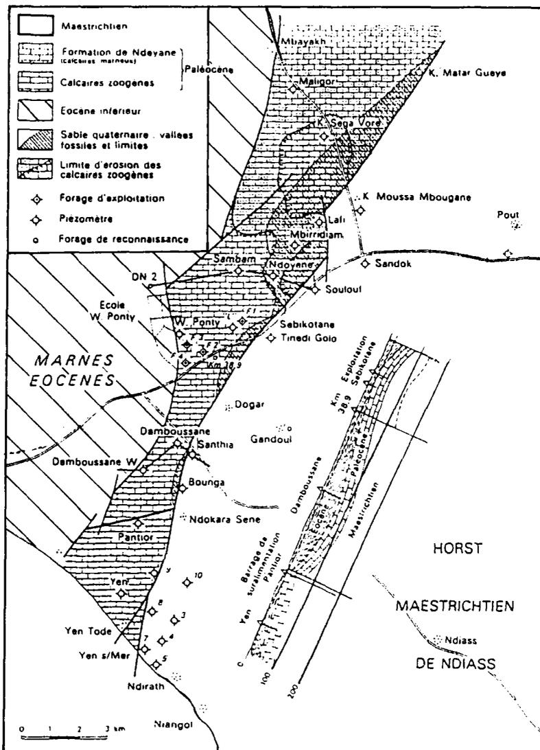
Figure 1. Ecorché du compartiment de Sébikotane. Extrait du rapport « les nappes de la presqu'île du Cap-Vert ». A. Martin, 1970.
