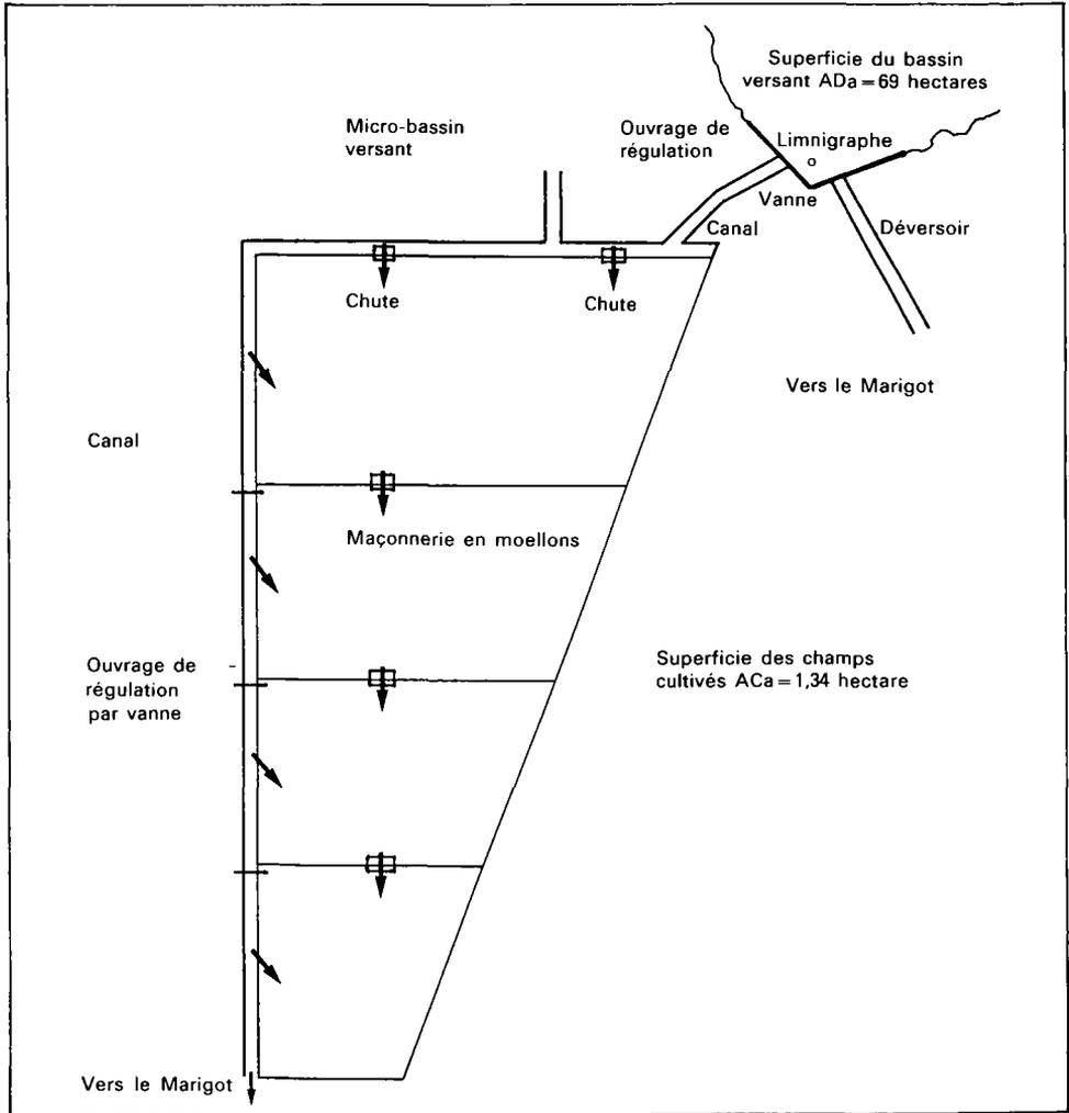
**Figure 2.** Système de distribution du périmètre A.
