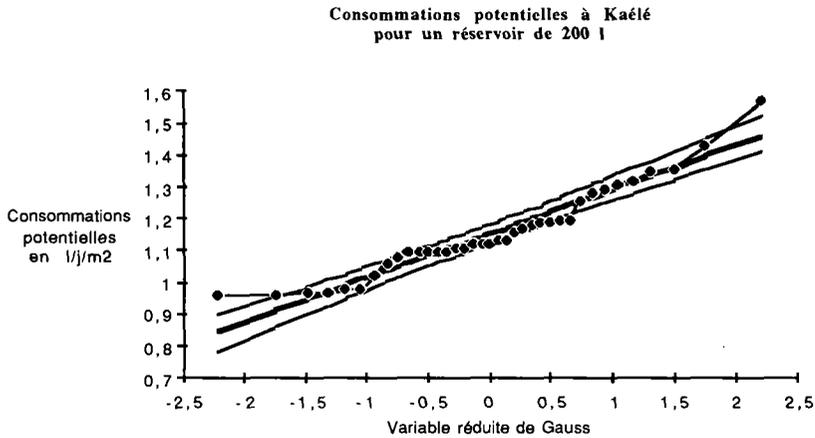
Figure 5. Ajustement à une loi de Gauss des consommations potentielles à Kaélé pour un réservoir de 200 l/m<sup>2</sup>.
