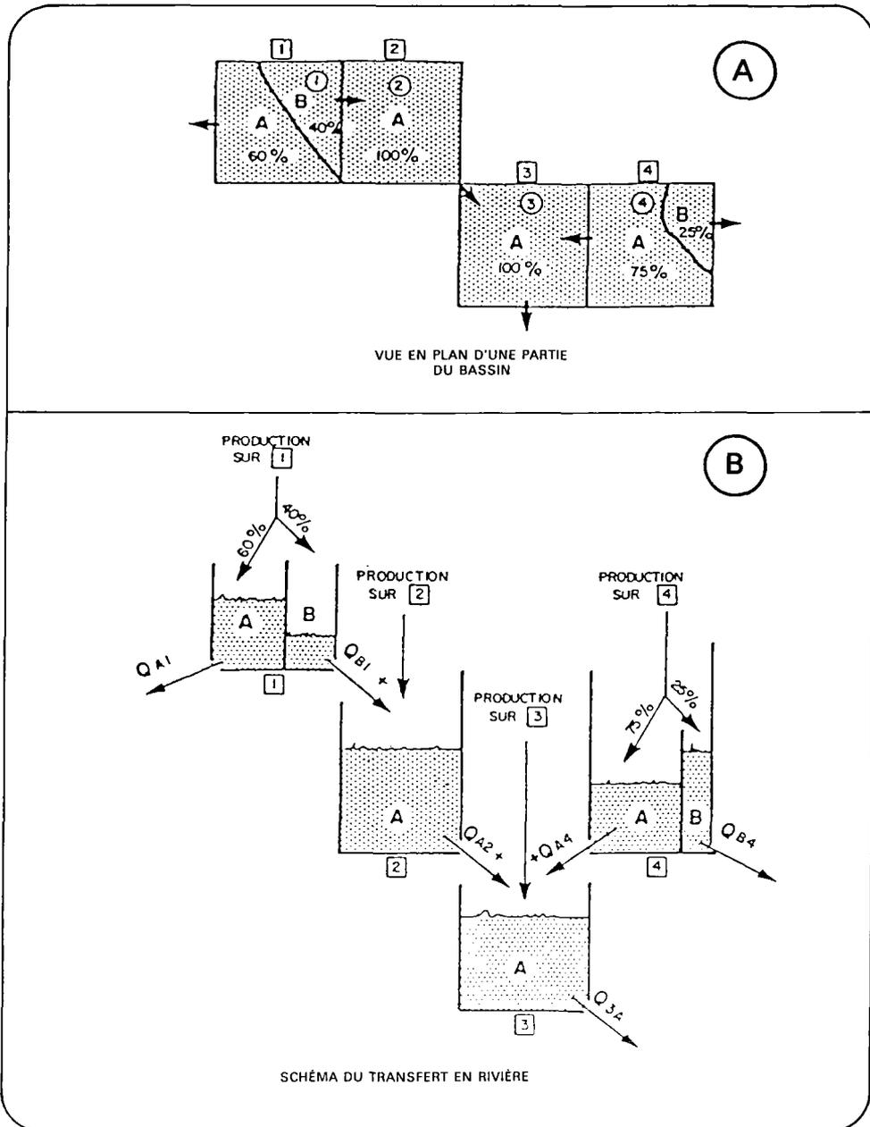
Figure 3. Schématisation de la fonction de transfert.
