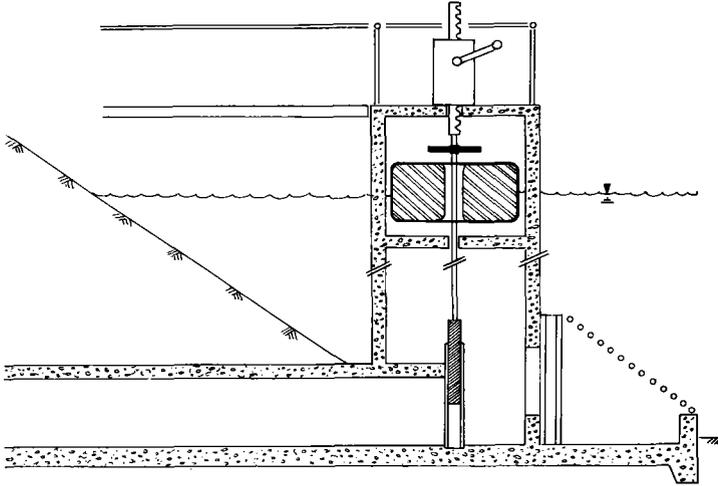
**Figure 3.** Schéma d'une vanne commandée par flotteur.
