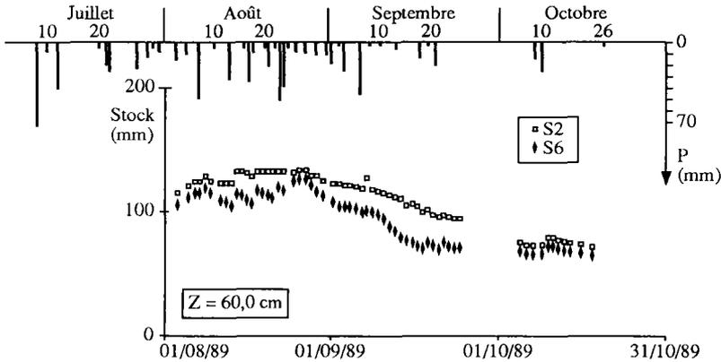
Figure 4. Pluviométrie et évolution des stocks d'eau dans le sol.
