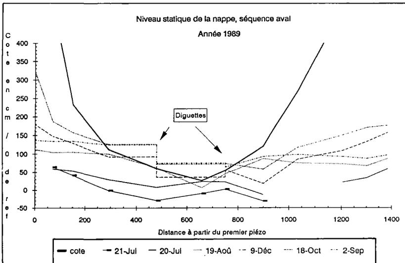
**Figure 9.** Niveau statique de la nappe, séquence aval. Année 1989.
