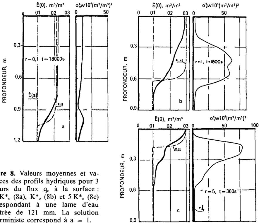
**Figure 8.** Valeurs moyennes et variances des profils hydriques pour 3 valeurs du flux  $q_0$  à la surface :  $0,1 K^*$ . (8a),  $K^*$ . (8b) et  $5 K^*$ . (8c) correspondant à une lame d'eau infiltrée de 121 mm. La solution déterministe correspond à  $a = 1$ .
