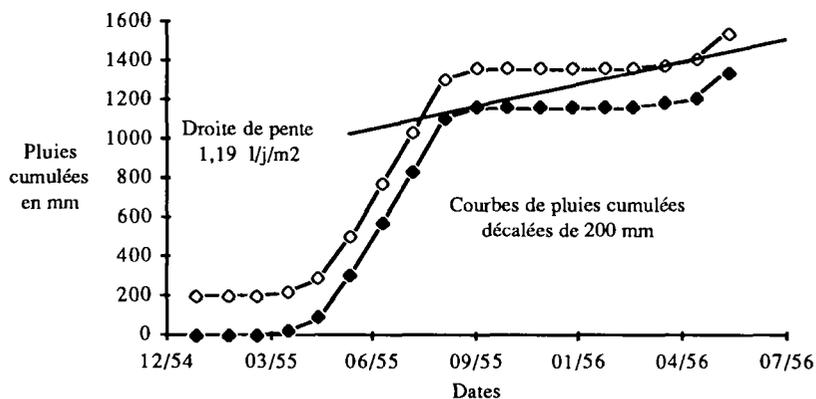
Figure 4. Détermination de la consommation potentielle pour un réservoir de stockage de 200 l/m<sup>2</sup>.
