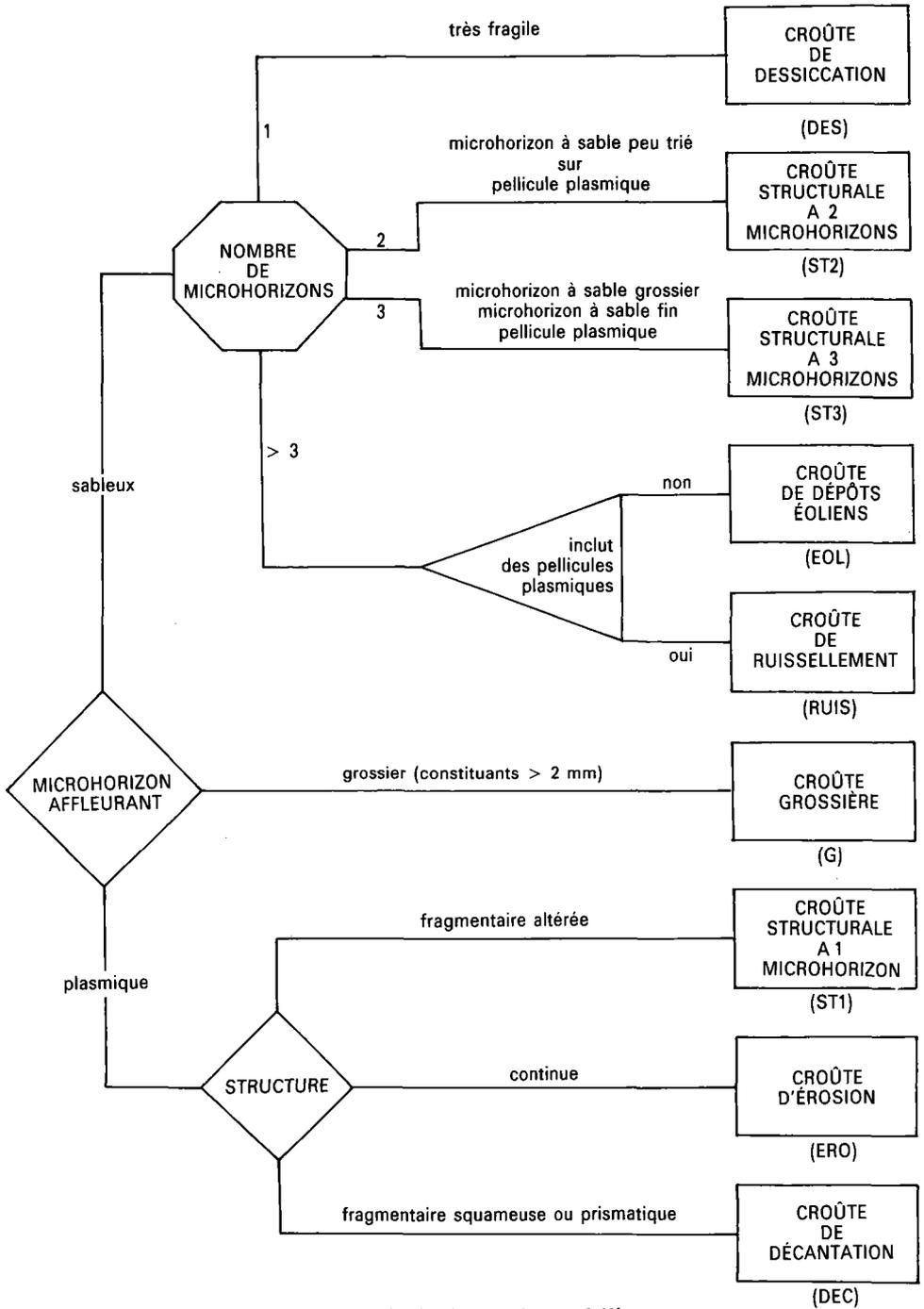
Figure 1. Clé de détermination des principales croûtes sahéliennes.
