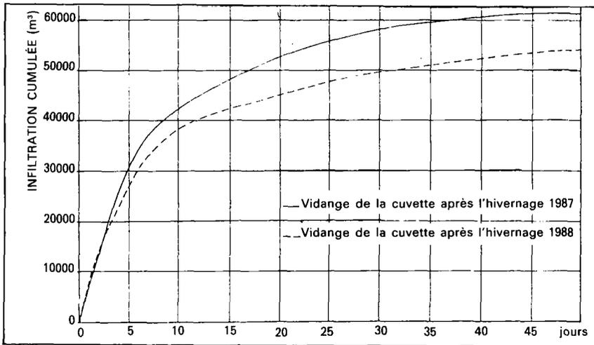
Figure 2. Comparaison de la vidange de la cuvette entre les hivernages 1987 et 1988.
