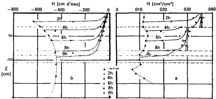
Comparaison entre : (a) les profils hydriques; et (b) de charge hydraulique expérimentaux et numériques, au cours de l'infiltration.
