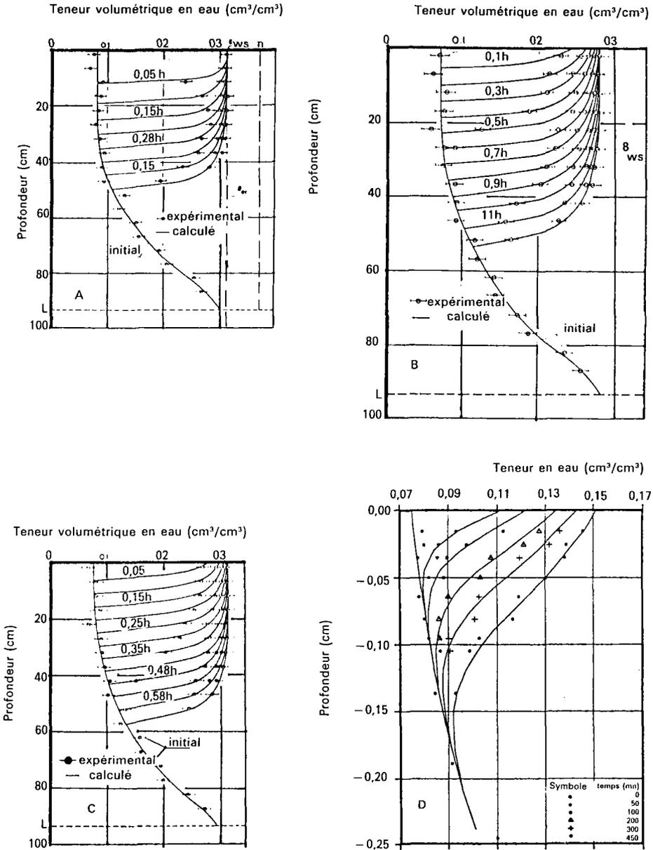
**Figure 1.** Exemples de comparaison observations/simulation dans les cas d'une infiltration submergeante (A); d'infiltrations sous flux inférieur (B) et supérieur (C) à la perméabilité à saturation; et d'une infiltration à travers une croûte superficielle (D). Les 3 premières figures sont tirées de Touma et Vauclin (1986), la quatrième est issue d'Aboujaoudé *et al.* (1990).
