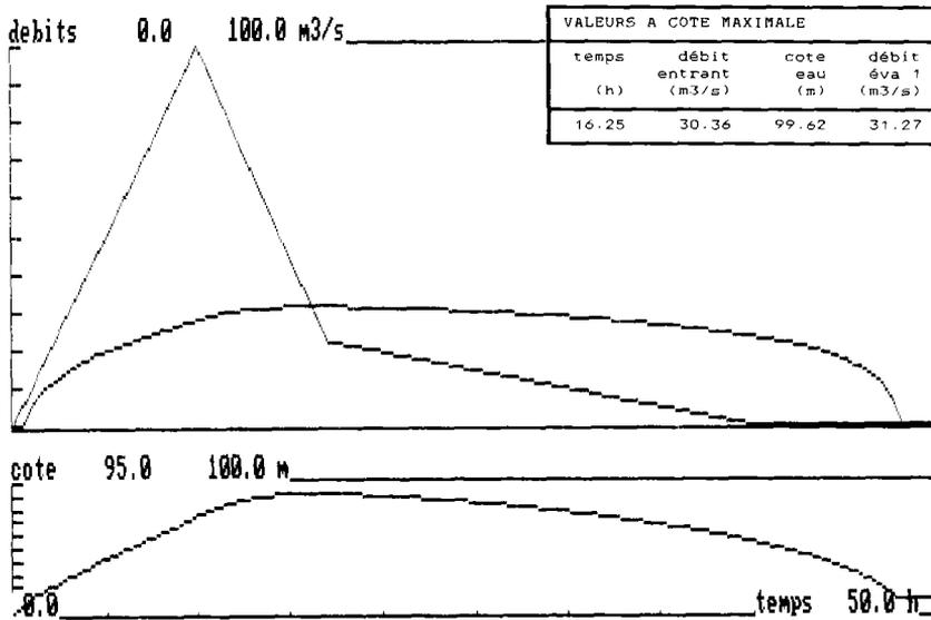
**Figure 5a.** Laminage de la même crue par un pertuis de fond de cale à la cote 95.50. Section du pertuis : 5,8 m<sup>2</sup>. Cote initiale du plan d'eau : 95.00.
