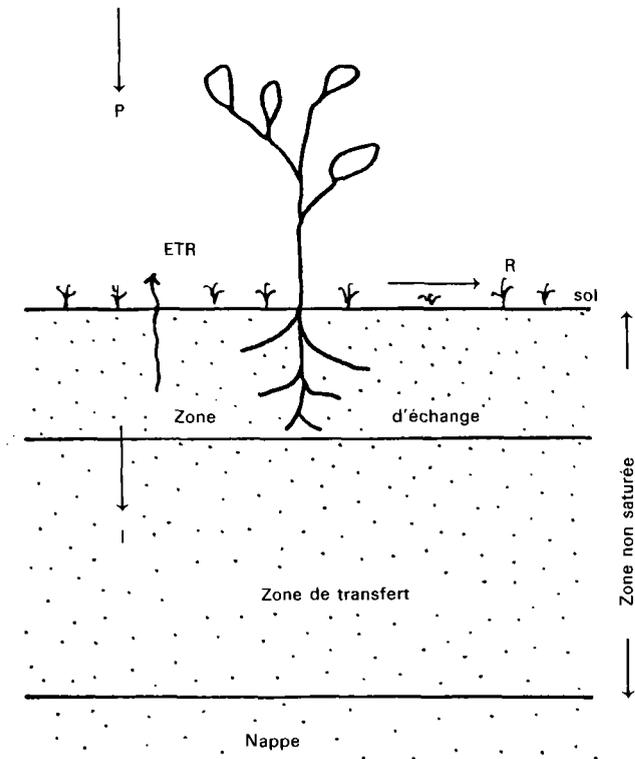
Figure 1. Schéma conceptuel du bilan de Thornthwaite.
