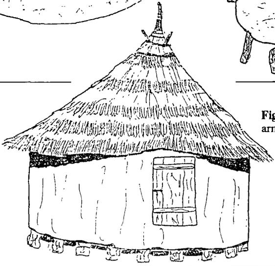
Figure 6. Grand grenier à armature de bambous tressés
