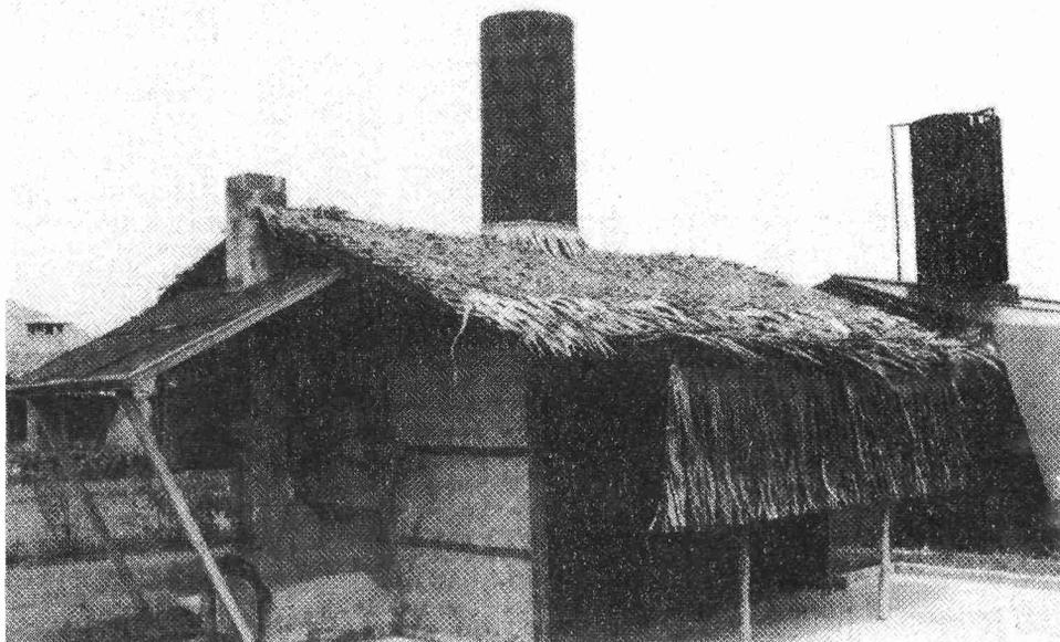
**A7.** Un séchoir de type magasin pour exploitation individuelle équipé du mécanisme d'aération en vortex, d'un cylindre de séchage rotatif qui permet à la fois de sécher et de stocker du riz non décortiqué, du blé, du manioc et d'autres produits. Il est chauffé par un four alimenté en briquettes de charbon d'enveloppes de riz.
